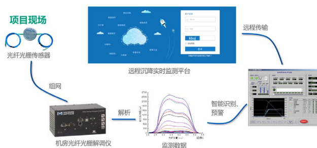
图3 监测系统示意图
