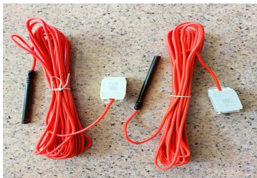
图2 电子雷管成品
