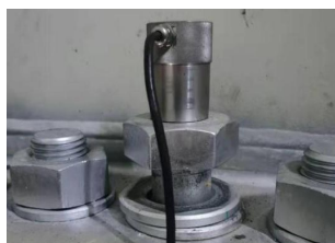
图 3 用手轻松将螺母松开 (轴力值低的螺栓连接)
