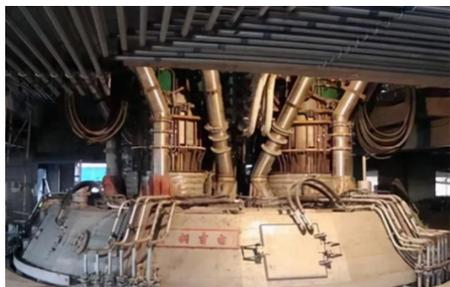
图1 工业电石炉设备的工作图
