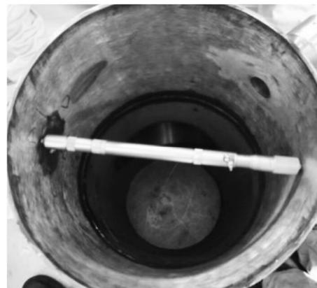
图 1b 千分尺分别测量 4 点管内径
