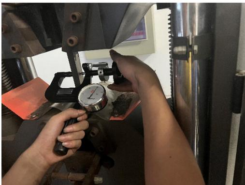
图 4 受拉试件硬度测量
