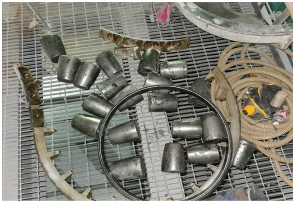
图1 磨损的空预器支撑轴承
