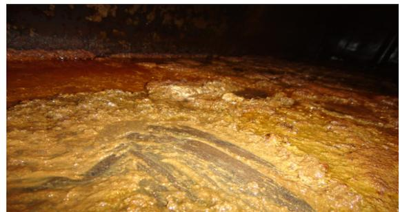
图3 汽轮机油箱中的油泥
