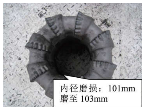
图 1 磨损的取心钻头
