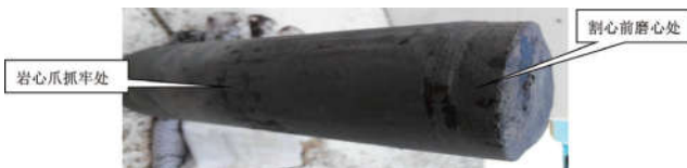
图3 岩心磨损图片
