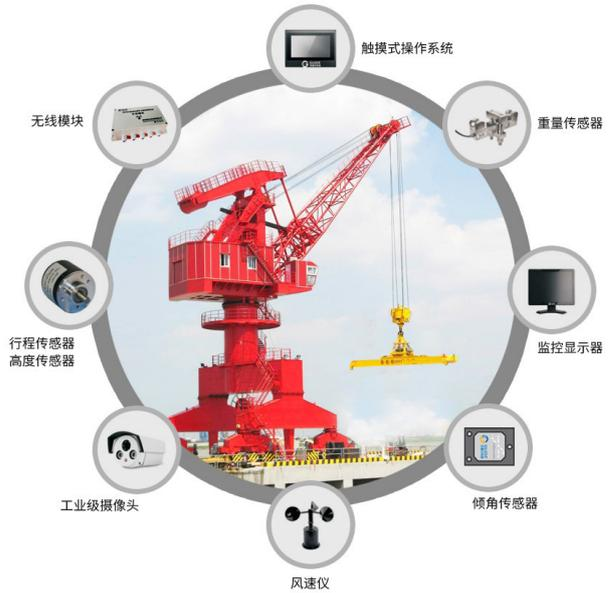
图1 门座起重机安全监测系统的构成
