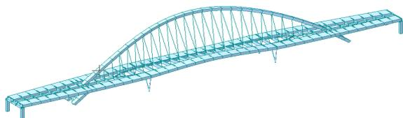
图 1 人行桥第一阶振动模态
