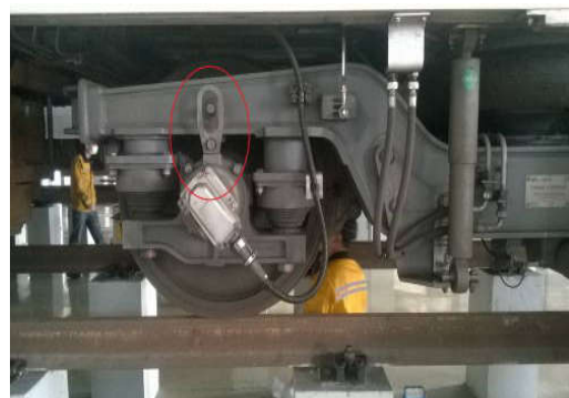
图2 轮对提吊安装位置实物
