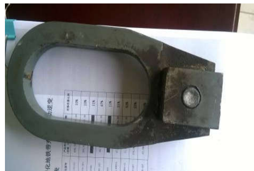
图1 断裂轮对提吊
