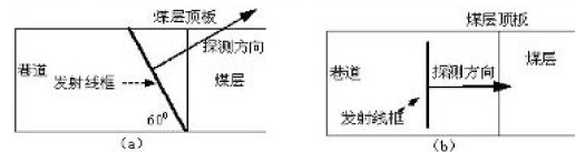
图 2 井下施工(底板)线框摆放角度示意
