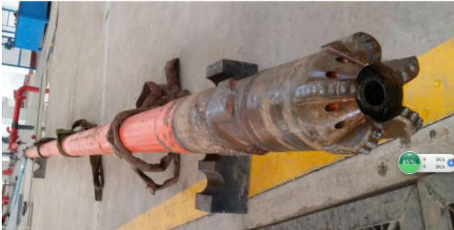
图 5 铝合金内筒配合液力加压取心工具进行室内试验
