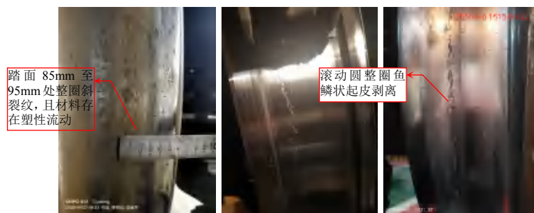
图 2 踏面剥离形貌示例
