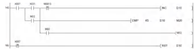
图 7 一楼滑槽坡下滞袋检测报警程序图
