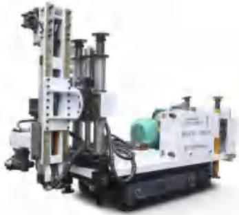
图1 煤矿用履带式全液压坑道钻机
