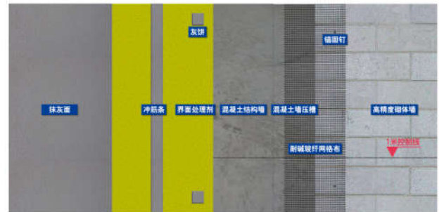
图1 薄抹灰施工工艺工序图
