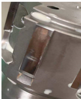
图 1 硬质合金导条有积屑瘤产生
