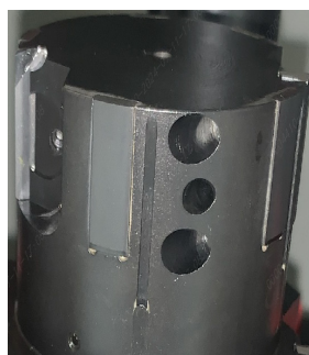
图 2 PCD 导条无积屑瘤
