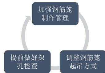
图 2 钢筋笼施工技术要点
