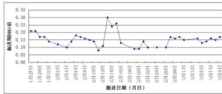
图3 11316下顺槽（西）掘进期间过 $F_{12}$ 断层带 $K_1$ 值情况
