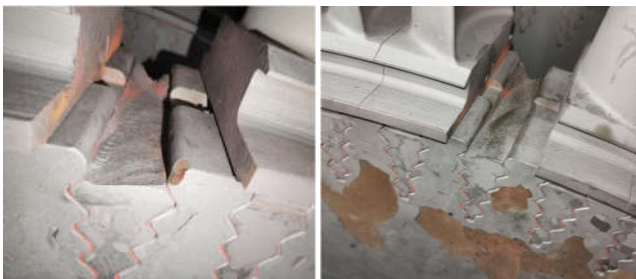
图2 27# 叶片断裂位置
