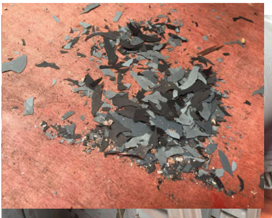
图10 斜齿枞树型叶根叶片结构形式及其氧化皮
