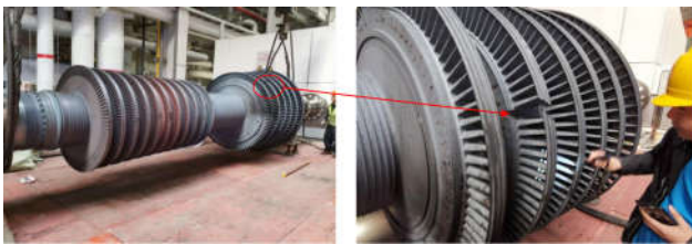
图1 中压转子和叶片
