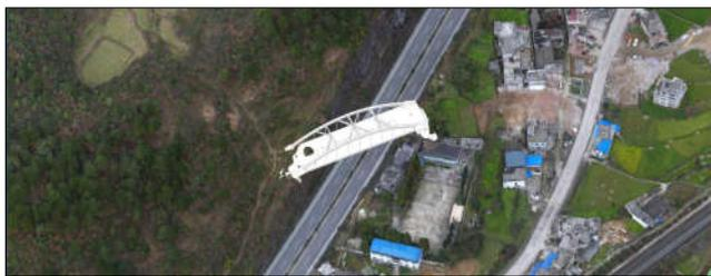
图6 麻芝铺大桥系杆拱桥方案研究模型(实景+BIM模型融合)
