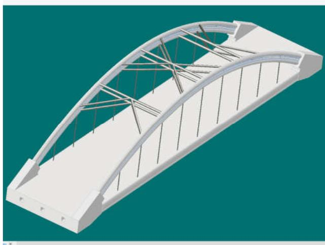
图3 麻芝铺大桥系杆拱桥上部结构三维模型图
