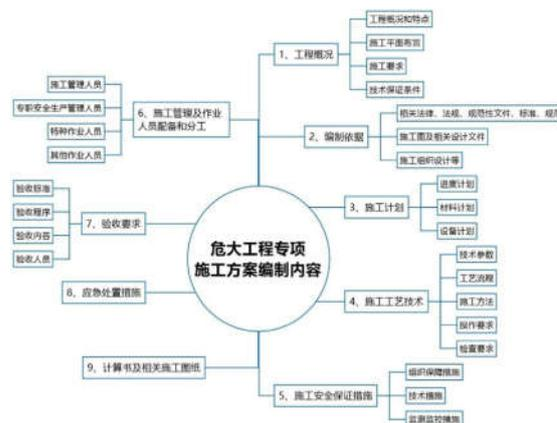
图4 危大工程专项施工方案编制内容图
