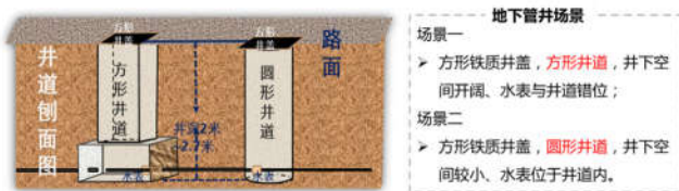
图1 地下管井NB智能水表示意图
