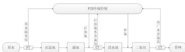
图2 PID串级控制原理图
