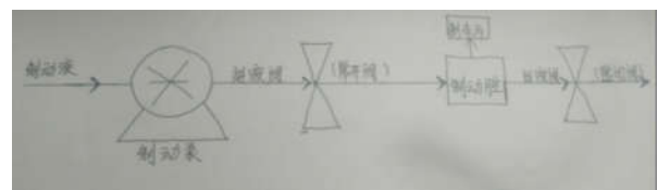
图 1 制动泵阀的工作原理图
