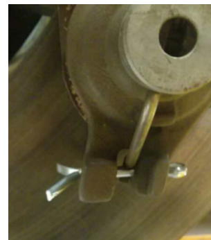
图1 CRH1 制动闸片防松
