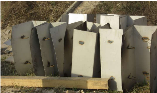
图 5 U 型不锈钢隔板实物图
