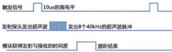
图 5 超声波传感器工作原理 1
