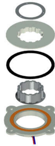
图4 得电制动器电磁铁的模型图
