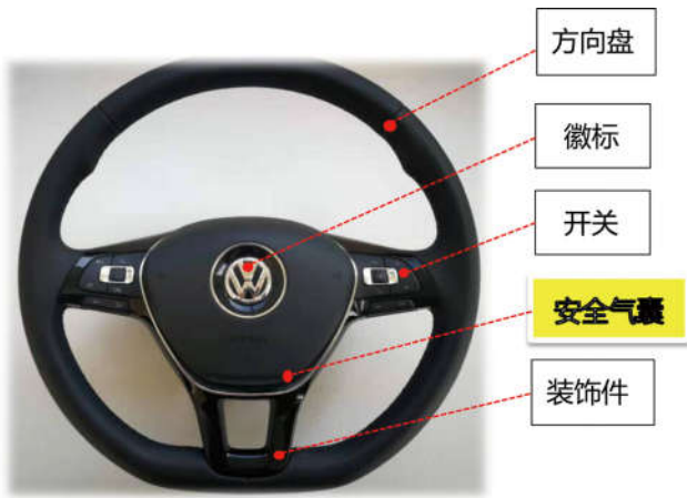
图1 方向盘总成主要构件
