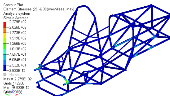
图 2 紧急制动工况应力云图
