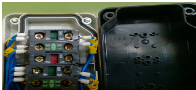
图4 旋钮内部触点接线
