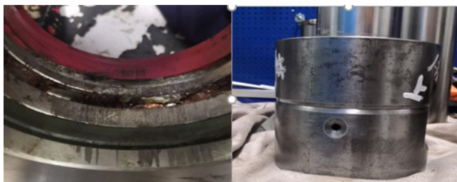
图3 柱塞泵故障现象
