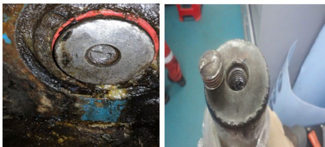
图1 柱塞泵故障现象
