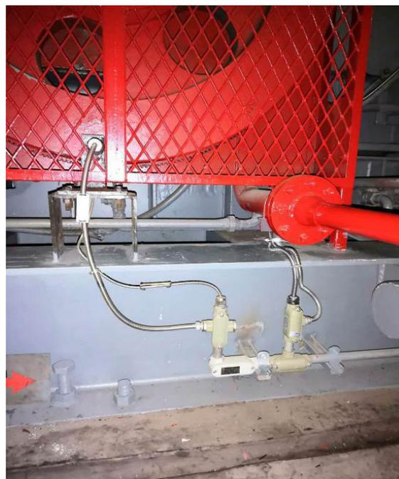
图 3 键相、瞬时转速传感器安装
