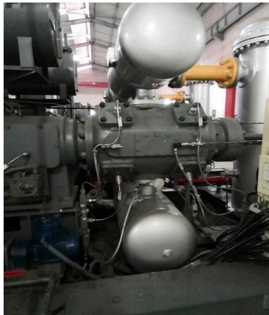
图 2 压缩缸检测传感器安装
