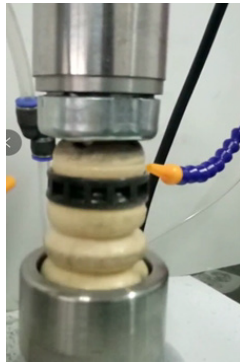
图8 缓冲块测试安装
