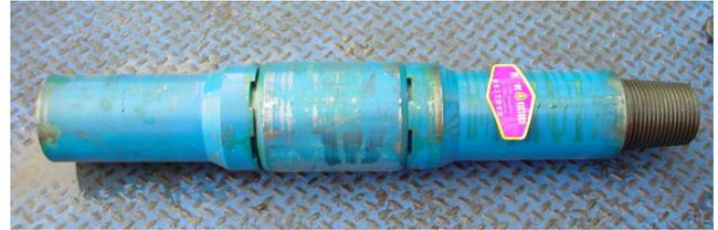
图4 FM-197防磨减扭接头
