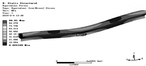
图8 主梁应力云图
