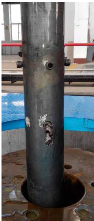
图7 优化设计后的磨铣套管试验
