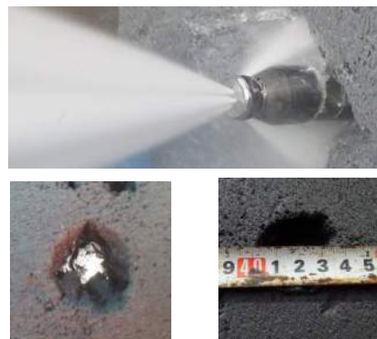
图 13 地层喷射试验
