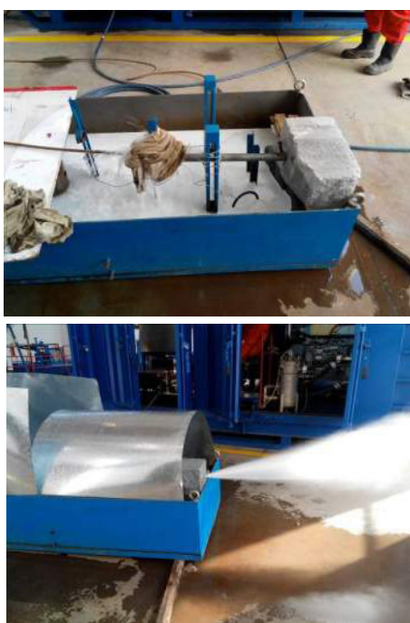
图 12 35Mpa 喷射破岩试验
