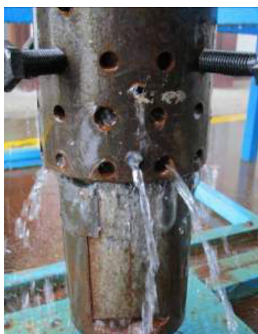
图5 使用改进后的钻头套管磨铣试验
