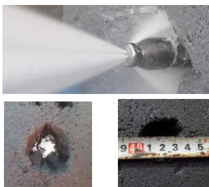
图 11 55Mpa 喷射破岩试验
