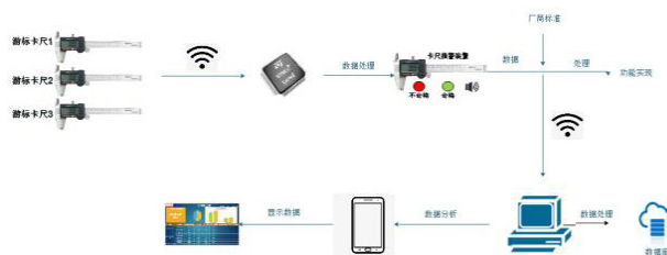
图 1 游标卡尺控制系统图
