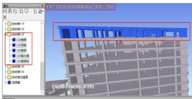
图 12 综合楼 13 层顶板实时过程对比 (b)
