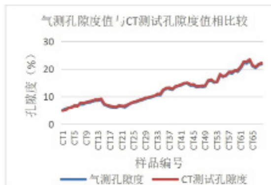
图5 气测孔隙度值与CT测试孔隙度值相比较
