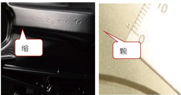
图4 涂膜出现缩孔以及颗粒图
