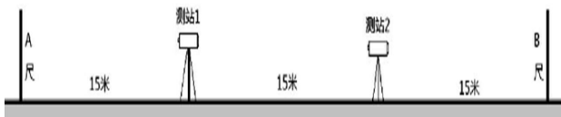
图1 数字水准仪电子 i 角测试图
