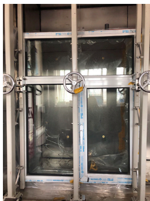
图 1 门窗气密性能安装示意图
