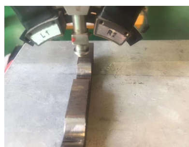
图 7 应力检测设备
