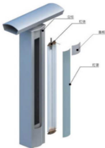
图 4 护栏立柱灯光构造图
