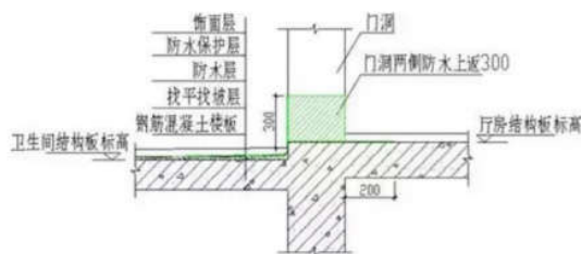
图2 厨卫地面防渗漏施工
