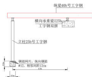
图 1 门洞支架纵断面示意图
