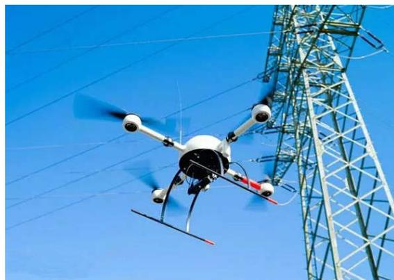
图 1 无人机巡检输电线路现场图
