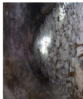
图6 “1切3平”试验区爆破效果
